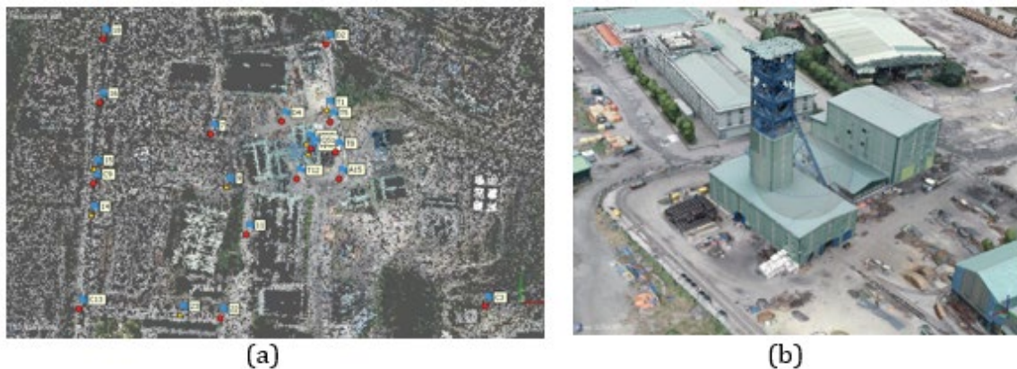
Hình 5. Kết quả xử lý ảnh UAV mặt bằng sân công nghiệp. (a) PC mật độ thưa và các điểm KCA (chấm tròn màu đỏ) và điểm KT (chấm tròn màu vàng); (b) PC dày đặc tháp giếng và các tòa nhà xung quanh.
